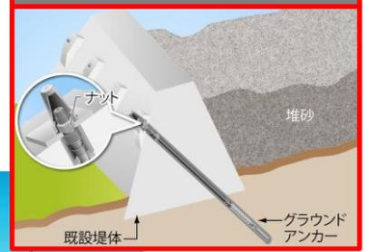
【砂防堰堤補強アンカー】
